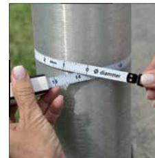
Durchmesser-/Umfangmessung in Anwendung
