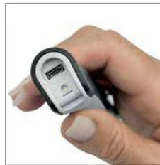
Aufladung über USB-Ladekabel mit Micro-USB-Anschluss
