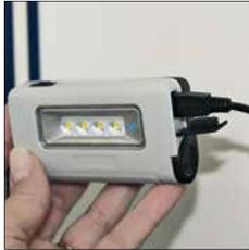
Aufladung über USB-Ladekabel mit Micro-USB-Anschluss
