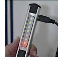
Aufladung über USB-Ladekabel mit Micro-USB-Anschluss
