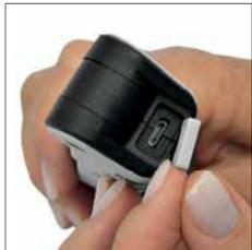
Aufladung über USB-Ladekabel mit Micro-USB-Anschluss
